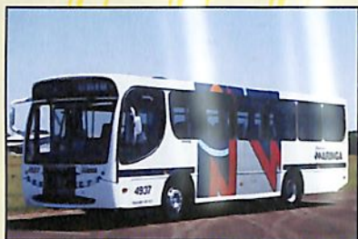
Já no transporte rodoviário, o investimento foi na compra de 15 novos ônibus equipados com motor Mercedes Benz OF 1417 eletrônico e carroceria Caio, modelo Apache Vip
