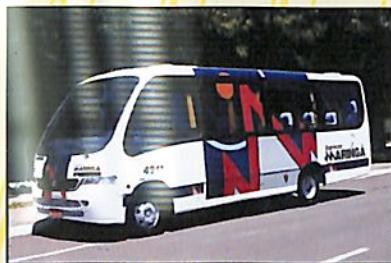
6 novos microônibus marca Mercedes Benz e carroceria Marcopolo modelo Senior GVC, que terão a finalidade de operar em linhas de baixa demanda, proporcionando assim mais frequência, aumentando o conforto dos passageiros
