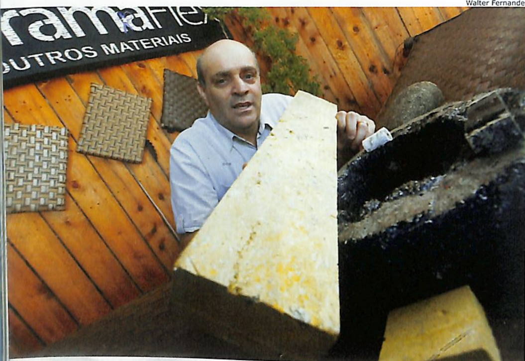
Nilson Maximiano desenvolveu um material que parece madeira, mas leva na composição restos de cola, tecido, plástico e outros materiais; ele procura parceiros para a produção em grande escala
